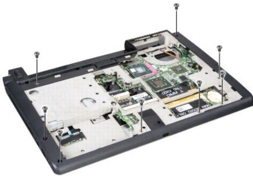
4. Entfernen Sie alle installierten Mini-Cards (siehe [Entfernen der Mini-Card](#)).
