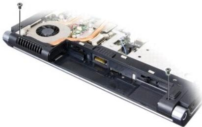
6. Entfernen Sie die zentrale Steuerungsleiste (siehe [Entfernen der zentralen Steuerungsleiste](#)).
